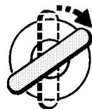
**3. Introducir el SEGUNDO dígito del código.** Si el segundo dígito es el 3, girar la llave a la posición de BLOQUEO tres veces. No olvidar: la llave debe volver hasta quedar EXACTAMENTE en la
