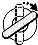
**1. Utilizando la llave**, girar la cerradura de la puerta del conductor a la posición de BLOQUEO 4 veces y volver a poner la llave en la posición central (como se ilustra) después
