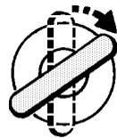
**5. Introducir el CUARTO dígito del código.** Si el cuarto dígito es el 1, girar la llave a la posición de BLOQUEO una vez. Asegurarse de que la llave vuelve hasta quedar EXACTAMENTE en la posición
